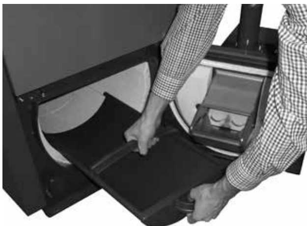
Przestrzeń spalania kotła wraz z ilustracją usuwania popiołu za pomocą popielniczki
