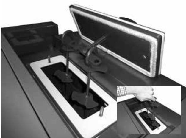
Ilustracja wyciągnięcia zwalniczy z wymiennika rurowego (dna sitowego) przed dokładnym wyczyszczeniem
